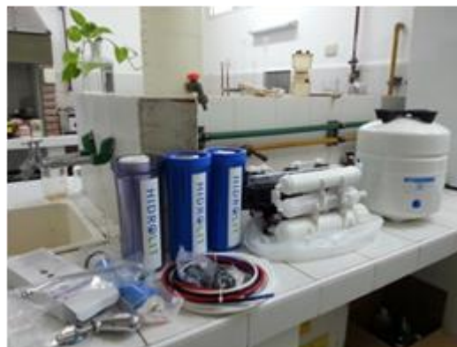
Fig. 10. Vista del equipo de Osmosis Inversa desarmado.
