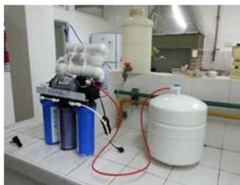
Fig. 11: Vista del equipo de Osmosis inversa con sus componentes interconectados.
