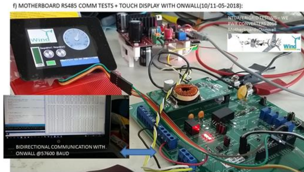
Fig. 17: Ensayos de Placa Madre en comunicación con Controlador Ownwall vía RS485 y Display
