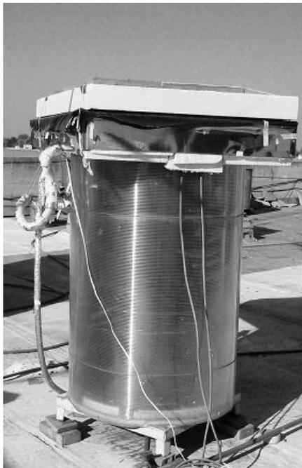
Fig. 1: Imagen del destilador convertido en CSA con la cubierta superior reemplazada por una placa de poliestireno expandido. En el lateral izquierdo se puede ver el conducto de recirculación usado para acondicionar y operar el sistema a las temperaturas de trabajo deseadas.
