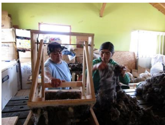
Fig. 15: Artesanas elaborando aislantes de lana suelta con el picker fabricado en el proyecto.
