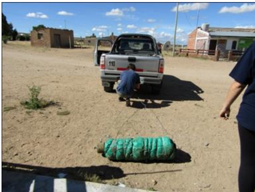
Fig. 9: Afieltrado con método mongol tirado por vehículo en reemplazo del tiro animal.
