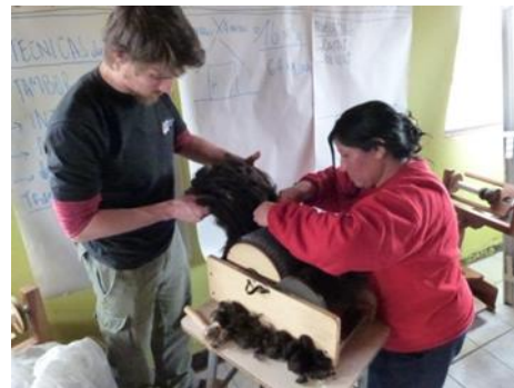
Fig. 6: Elaboración de la lana cardada.
