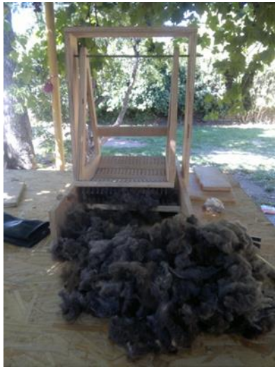
Fig. 10: Abridora o picker en seco manual
