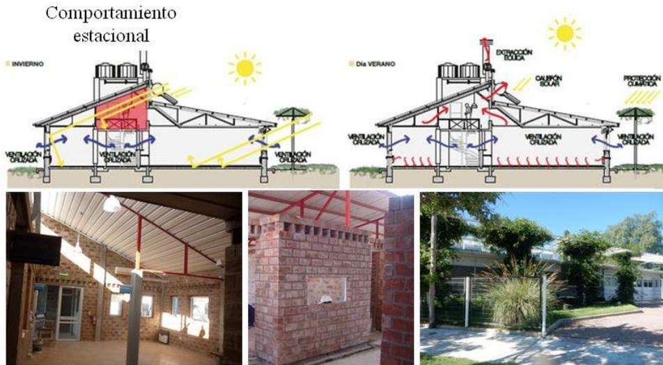
Fig. 5: Estrategias de climatización según los puntos 3, 4 y 7 de la etapa de diseño
