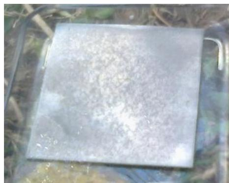
Fig. 1: (a) Superficie afectada por la corrosión y (b) Superficie decapada durante 5 minutos.
