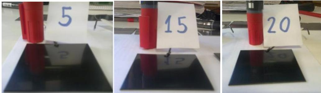
Fig. 5: Sustratos pavonados con tiempo de inmersión en el baño de, (a) 5 minutos, (b) 15 minutos y (c) 20 minutos.
