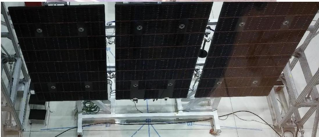
Fig. 3. Paneles SAOCOM 1A en el Laboratorio de Integración de CNEA (arriba) y con mecanismos y desplegados en las instalaciones de INVAP – CEATSA (abajo)
