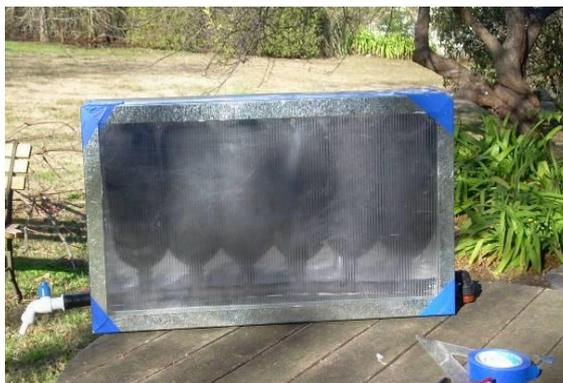
Fig. 4. Colector acumulador de botellas plásticas recicladas tipo valija. Suple las necesidades en casos de excesiva precariedad e inexistencia de tanques acumuladores de agua.
