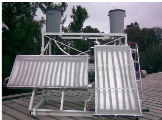
Fig. 6. Calefones solares en escala real, con cañerías de polietileno de 2" en disposición horizontal o vertical según los requerimientos de instalación en el terreno.
