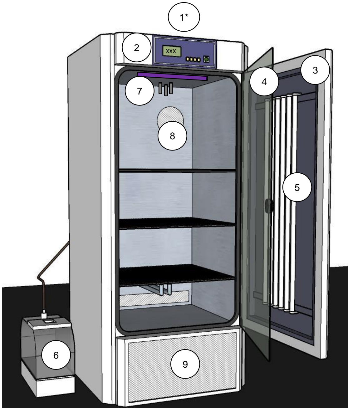
Figura 3.1. Imagen digitalizada de la incubadora de crecimiento donde se puede observar el sistema operativo de funcionamiento.: (1) Sistema de control con microprocesador de control de temperatura, luz y humedad (*) ubicado en la parte superior interna de la incubadora, (2) Pantalla digital de sistema de control, (3) Puerta exterior de metal, (4) Puerta interior vidrio, (5) Sistema de iluminación, (6) Humidificador, (7) Sensores de humedad y temperatura, (8) Sistema de circulación de aire, (9) Sistema de refrigeración tipo alternativo de compresor hermético.
