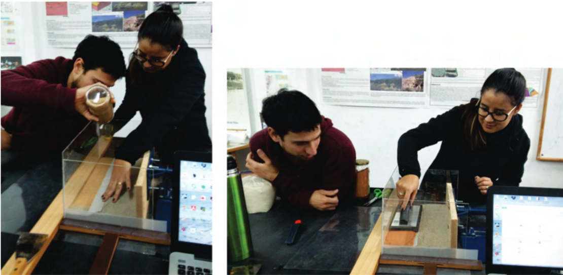
Figura 5. Preparación del modelo: sedimentación de las capas de arena que representan capas geológicas.
