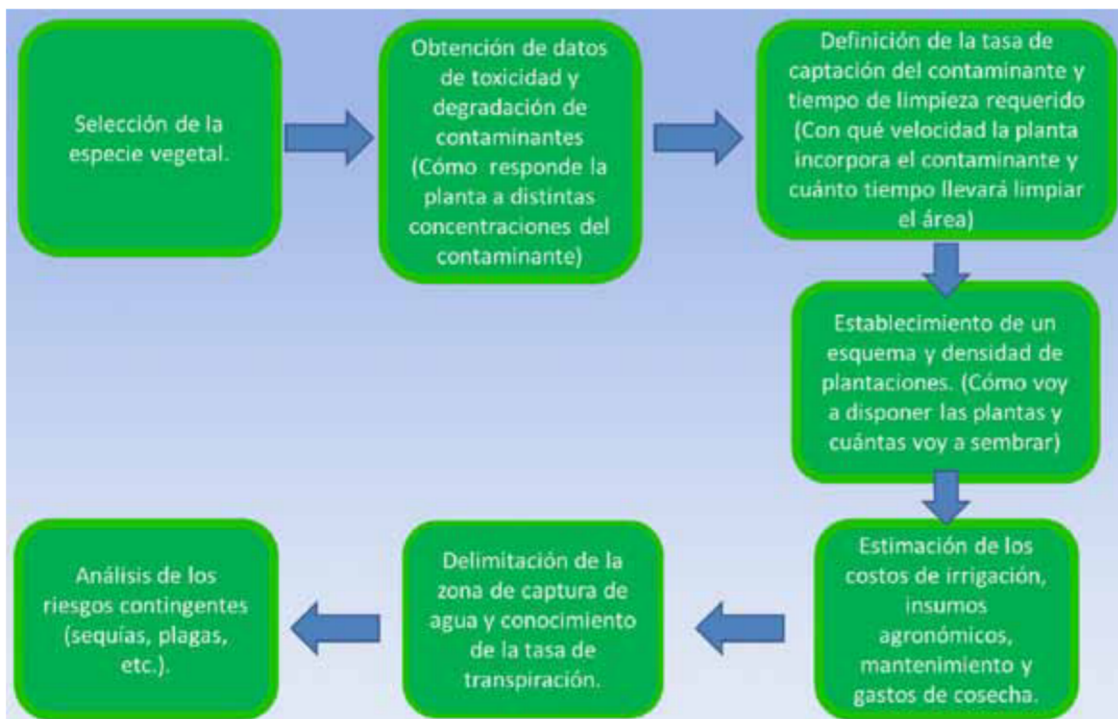
Figura 2. Pasos a seguir y tener en cuenta a la hora de plantear un esquema de fitorremediación
