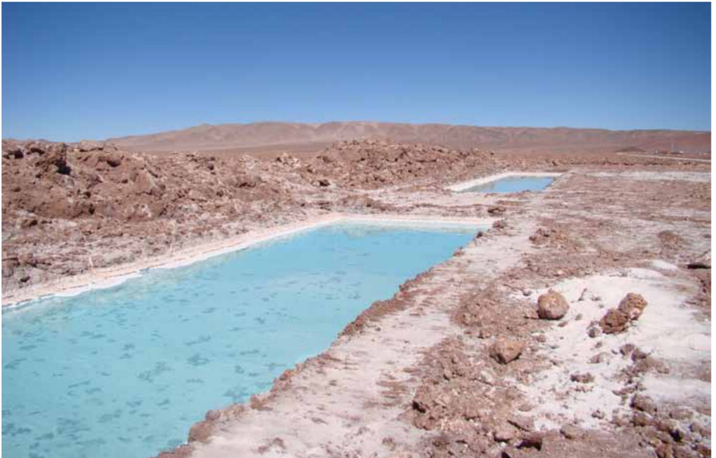
Figura 8: Piletones de prueba para evaporación en el Salar de Pozuelos, Provincia de Salta – Cortesía EKEKO S.A.
