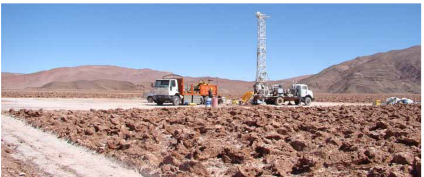
Figura 9: Perforación para exploración en el Salar de Pozuelos, Provincia de Salta – Cortesía EKEKO S.A.
