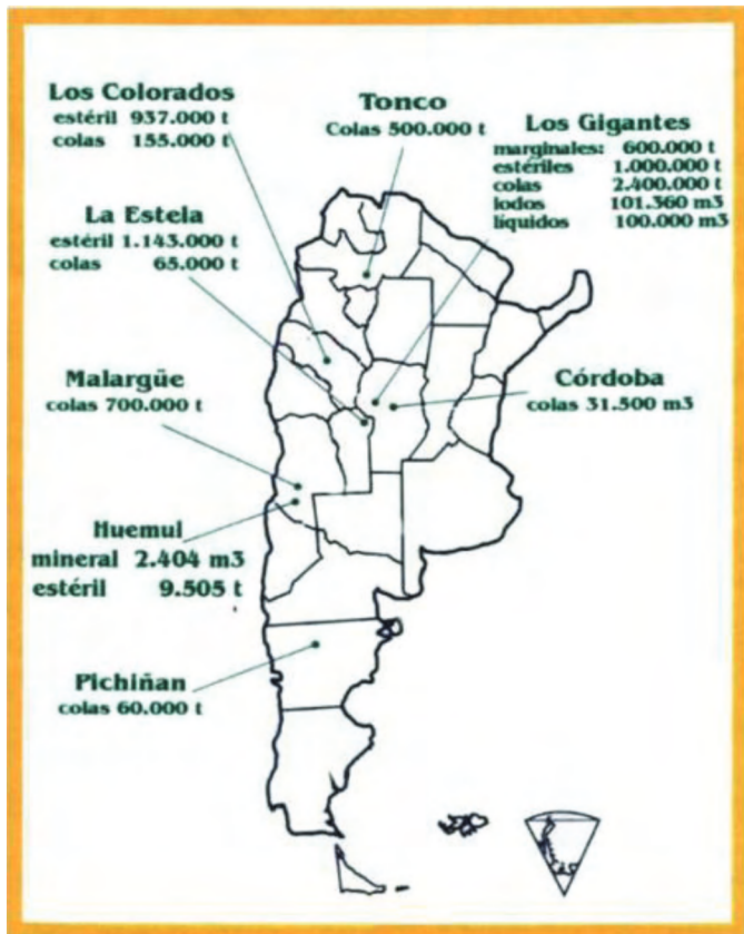
Figura 1. Mapa de localización de las 8 minas de Uranio abandonadas de la CNEA. Debajo de la denominación de cada mina se detallan la cantidad y tipo de residuos que no han sido tratados y dispuestos de manera adecuada.
