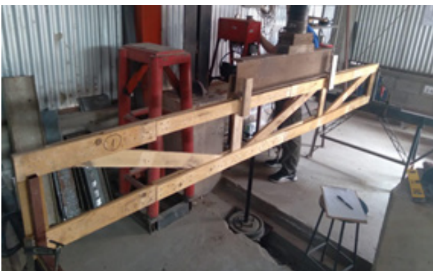
Fig. 8: Ensayo en cercha rectangular. Elaboración propia.
