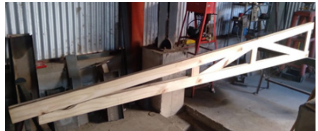
Fig. 10: Ensayo en cercha testigo triangular con madera comercial. Elaboración propia.
