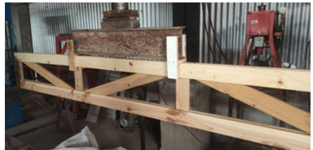
Fig. 9: Ensayo en cercha testigo rectangular con madera comercial. Elaboración propia.
