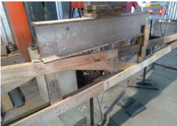
Fig. 7: Ensayo en cercha triangular. Elaboración propia.
