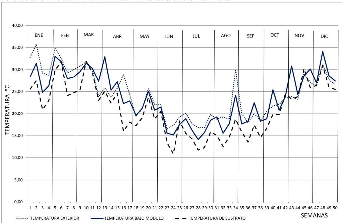
*Figura 6: Medición comparativa de temperaturas en baldosas modulares circulares de sustrato, bajo el dispositivo y temperatura ambiente exterior. Período: Enero 2015-Diciembre 2015.*
