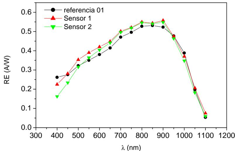
Figura 4. Respuesta espectral de dos sensores elaborados
