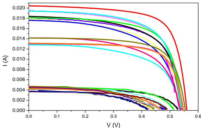
Figura 3. Curva IV de sensores de distintas áreas.
