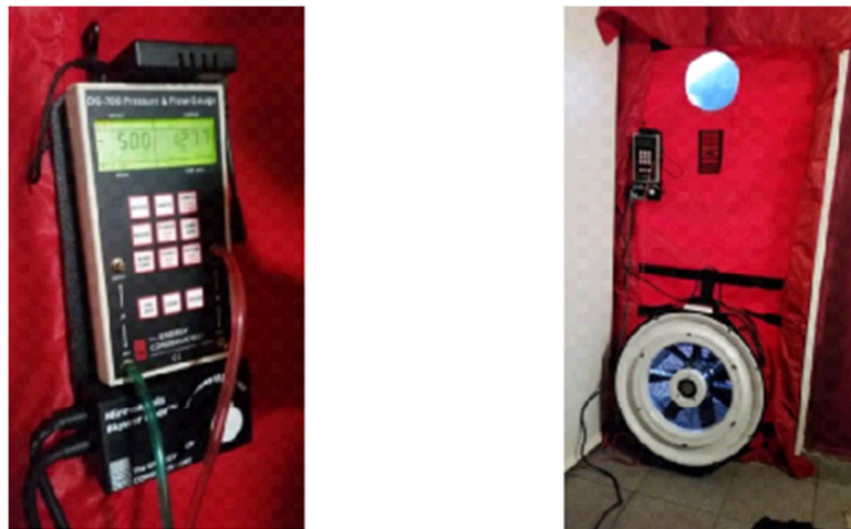
Figura 4: Equipo Standard Model 3 Minneapolis en funcionamiento realizando el ensayo de presurización en la puerta de ingreso a la vivienda.
