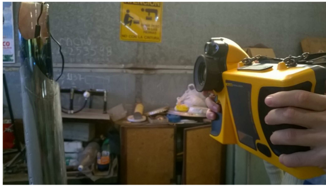
Figura 9: Experiencia para la medición de la emisividad de la superficie del absorbedor
