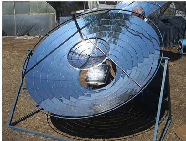
*Figura 1. Concentrador solar de Fresnel*
