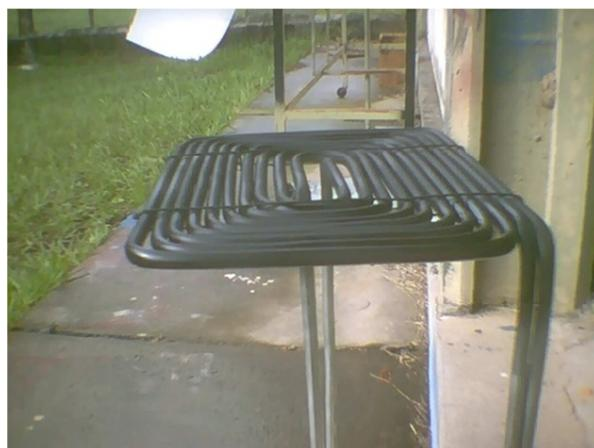
*Figura 2. Espira doble absorbidora colocada en el volumen focal del concentrador*
