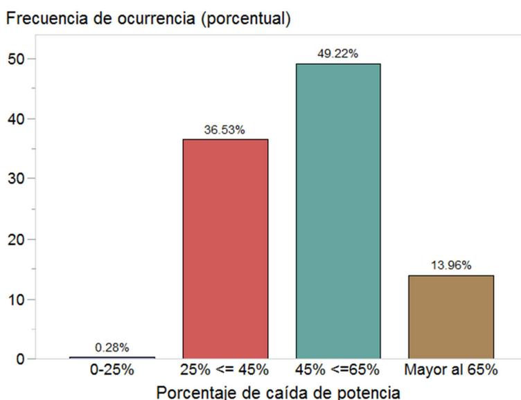
Figura 10: Porcentaje de caída de potencia en un minuto debido a caídas de irradiancia mayores a 300 W/m<sup>2</sup>
