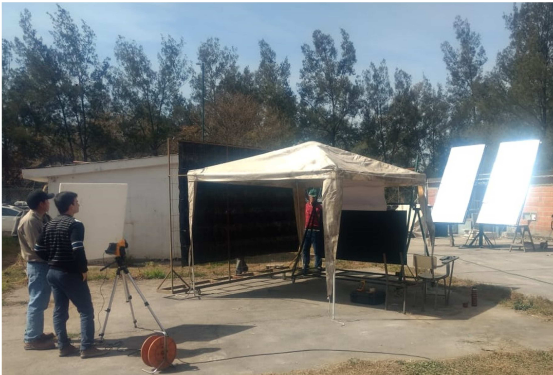
Figura 8. Ensayo in situ: la pantalla es iluminada por el helióstato en una cara, y las imágenes termográficas son tomadas sobre la otra
