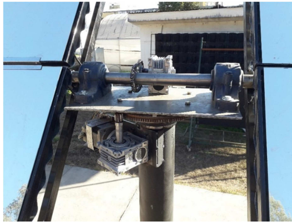
Figura 4: Mecanismo para movimiento en dos ejes
