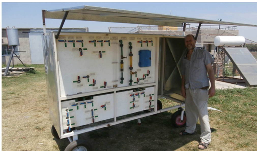
Figura 4: Máquina móvil para ensayos múltiples de colectores solares y sistemas compactos para calentamiento de agua.
